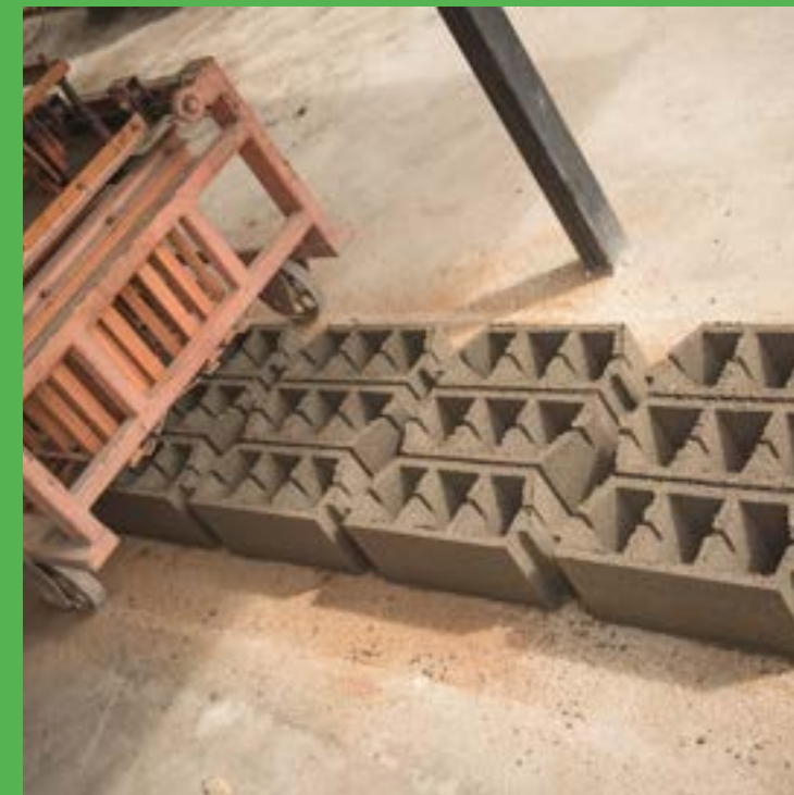
Phase de moulage sous pression avec machine à vibration
